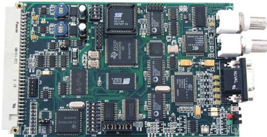
**Sindsp-5409** è una scheda prodotta da *Sinartis* per applicazioni *embedded* in ambito industriale dove risultano necessari la cattura, la visualizzazione e l'elaborazione di immagini video in modo autonomo (*stand-alone*) senza l'impiego di un computer.
